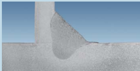
A utilização em Soldadura MIGp de VARIGON® He30S facilita a ligação entre chapas de espessuras muito diferentes, neste caso de 3 e 8 mm
