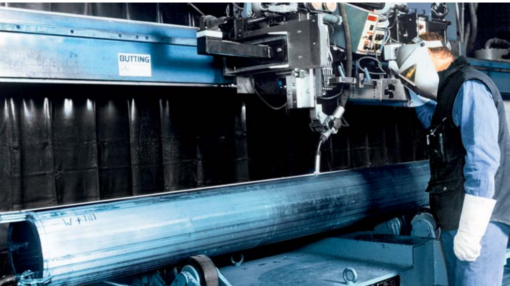
Produção de um rolo para um forno de Microfer® 6025HT/liga 602CA com CRONIGON® Ni30. (fonte: H. BUTTING GmbH & Co. KG)
