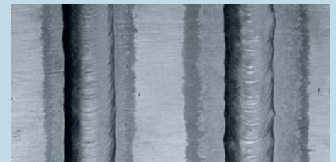
Estabilização do arco com VARIGON® S (à esquerda) em comparação com argon (direita)
