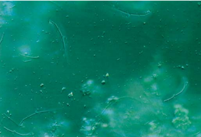
Flocos mal estruturados provocados pelo fornecimento insuficiente de oxigénio na estação de tratamento de águas de uma cervejeira.
