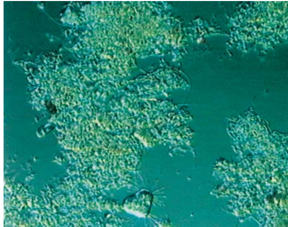
Flocos de lama bem desenvolvidos após 14 dias de tratamento com oxigénio puro.
