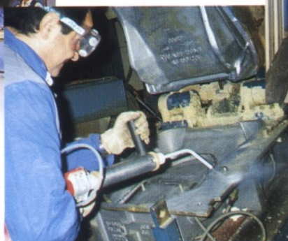
Limpeza de materiais e superfícies por projecção de pellets de gelo seco
