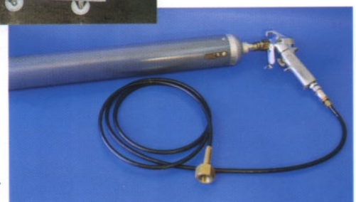
Limpeza de materiais e superfícies por projecção de pellets de gelo seco
